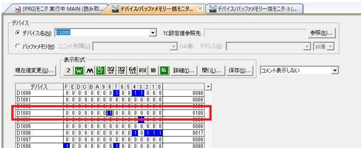
2. 一旦 M3001 を OFF にし、RFID タグをヘッドに読み込ませた状態で、再度 M3001 を立ち上げ、D1003.0(0x0002 Tag present at read/write head)が 1 になることを確認します。D1003.0 が 1 にならない場合、RFID タグ読み取り時のヘッドの LED 状態の再確認、1.6.2 で設定した通信プロトコル設定の再確認、Remote I/O のリブート等をお試しください。
