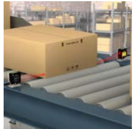
距離を測定することで物体の幅を検出可能
