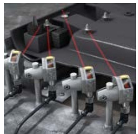
小さいスポット径でナットの有無も検出可能 タクトタイムを短縮
